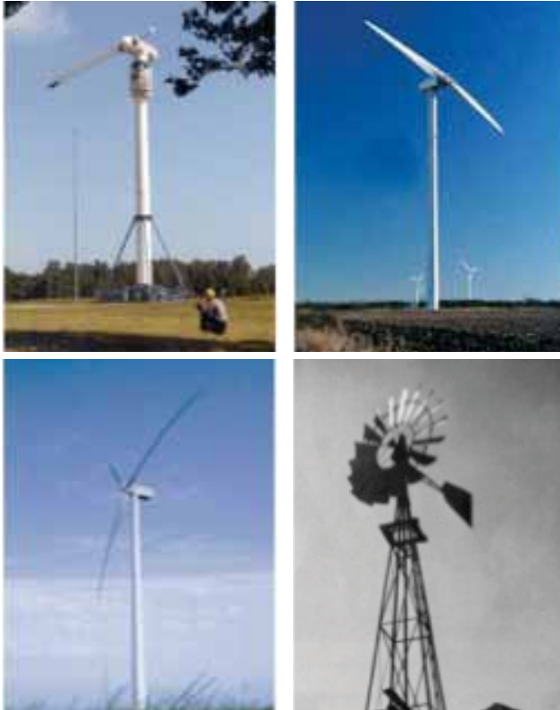
Şekil 1. Tek (sol üst), çift (sağ üst), üç (sol alt) ve çok kanatlı (sağ alt) yatay eksenli rüzgâr türbinleri [1]
