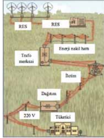
Şekil 4. Rüzgar enerji santrallerinde elektrik enerjisi iletimi [6]
