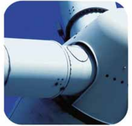
10.9 High Tensile Stud Bolts & Blade Nuts 10.9 Kalite Kanat Bağlantı Saplama ve Özel somunları
